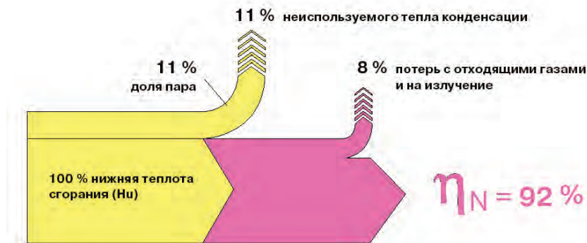
Рис. 4: КПД современного конвективного (обычного) котла при работе в системе отопления 75/60 °C.
